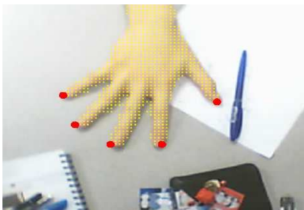
Figura 3.4: Segmentação da mão e determinação das pontas dos dedos (WANG et al., 2009).
