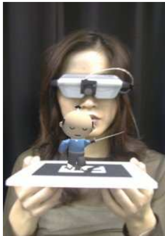
Figura 2.17: Exemplo de aplicação de Realidade Aumentada utilizando ARToolKit (KATO et al., 2010).
