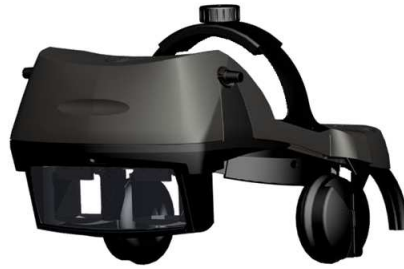
Figura 2.13: Exemplo de HMD a tecnologia “ optical see-through ” (NVIS Inc., 2010).
