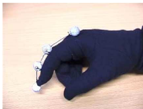
Figura 3.1: Luva com marcadores retrorreflexivos (DORFMÜLLER-ULHAAS; SCHMALSTIEG, 2001).
