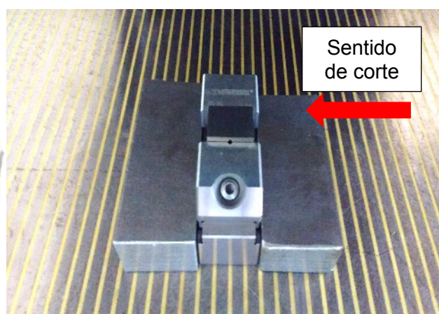
b) Vista frontal/superior do sistema peça-morsa-mesa da retificadora
