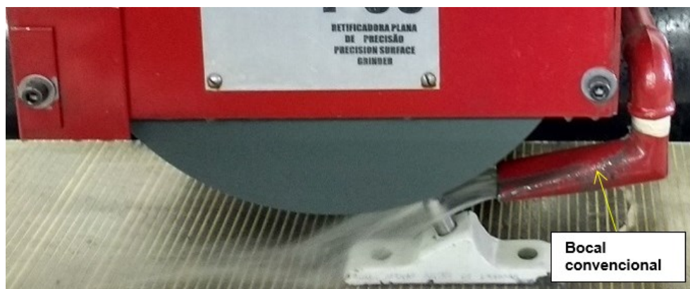
a) Técnica convencional com bocal convencional
