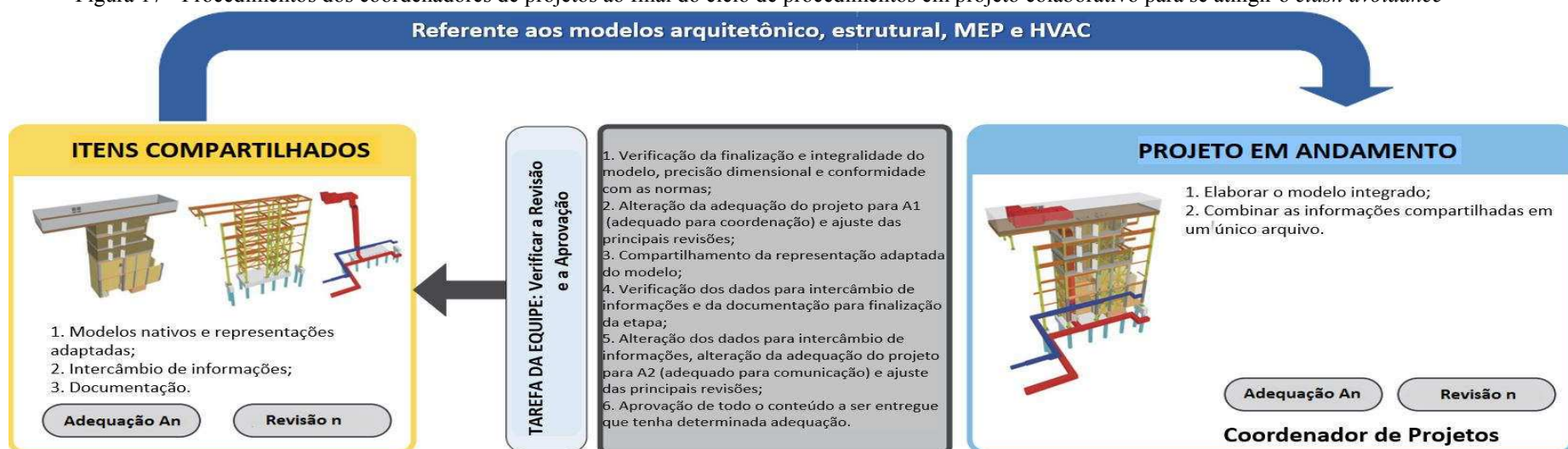
Figura 17 - Procedimentos dos coordenadores de projetos ao final do ciclo de procedimentos em projeto colaborativo para se atingir o clash avoidance
