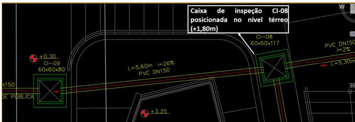
Figura 34 - Encaminhamento do esgoto sanitário da caixa CI-08 para a caixa CI-09
