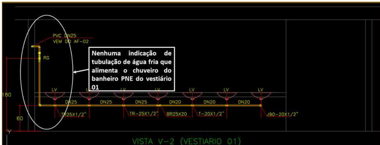
Figura 33 - Vista V-2 sem indicação de válvula de pressão ou tubulação que alimenta o chuveiro PNE
