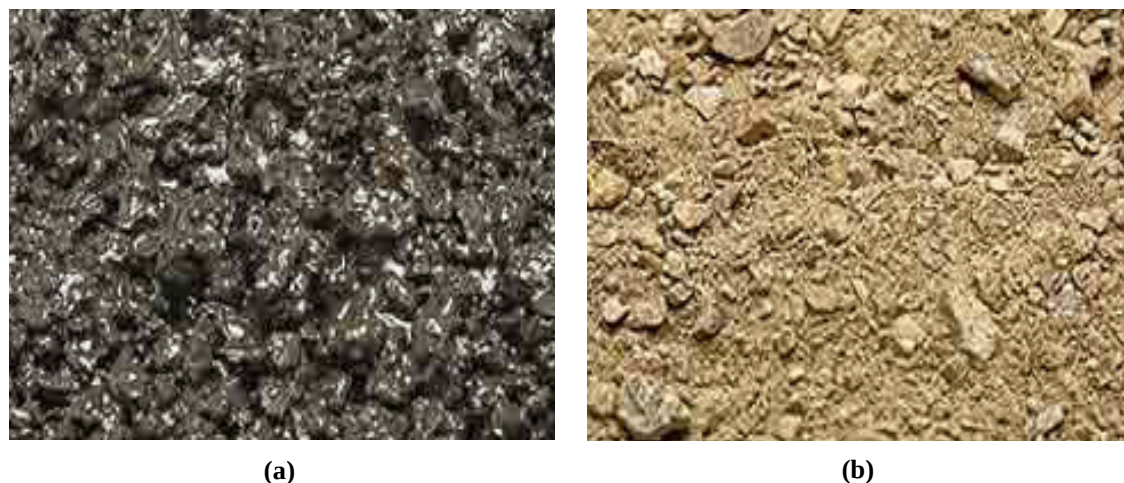
Figura 2.14 - Comparação entre o cascalho molhado (a) - 12% - e seco (b) - 3%.
