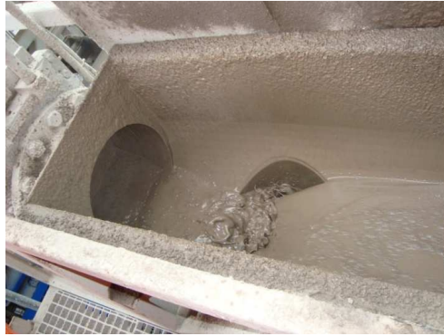
Figura 2.1 - Fluido de perfuração sintético que retorna do poço sendo perfurado.
