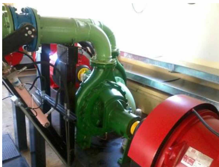
Figura 16 Bomba Funcionando com Turbina - experimento
