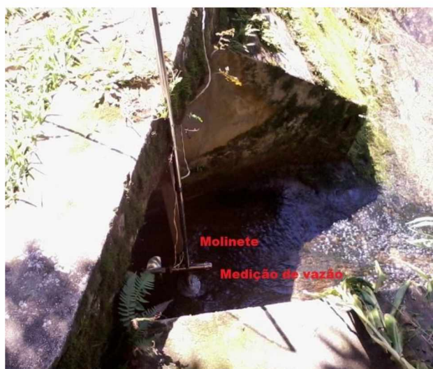
Figura 40 Medição de vazão. Fonte: Foto do autor.
