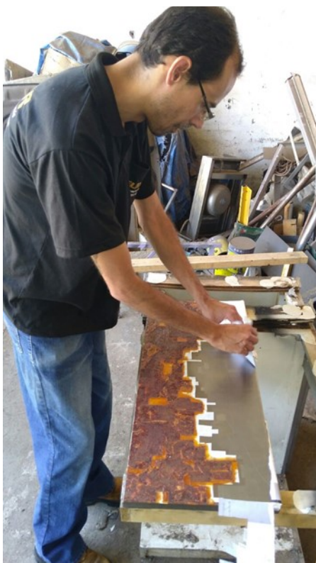
Fig. 16: retirando fita adesiva usada como máscara em uma das placas
