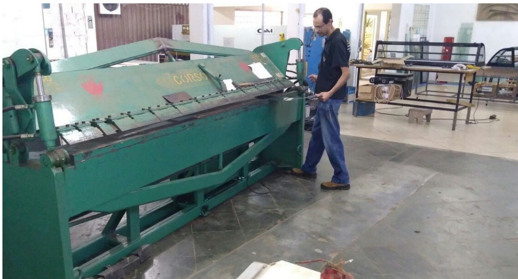
Figura 02: trabalho no ambiente da fábrica: operando a dobradeira hidráulica de chapas metálicas
