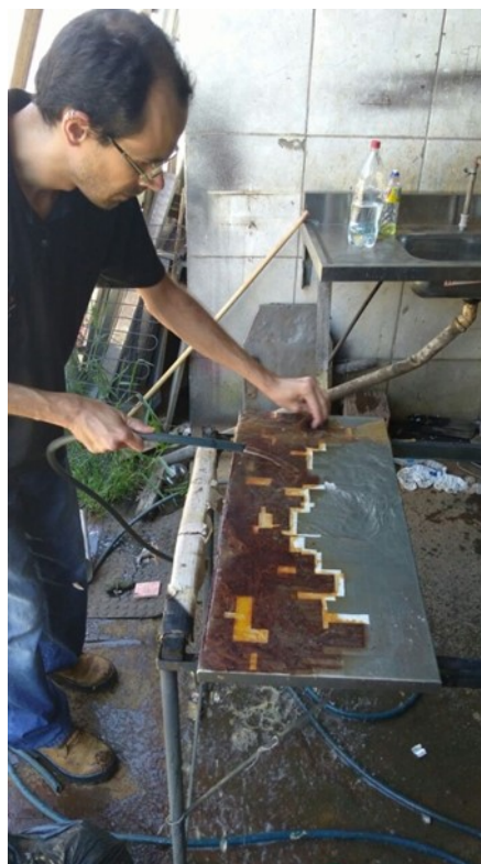
Fig. 17: lavando a placa a fim de retirar o excesso de oxidação provocada pelos ácidos
