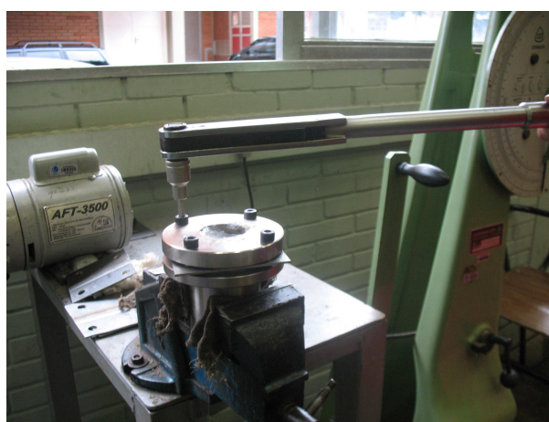
Figura 3.20. Torquímetro utilizado para padronizar a pressão aplicada na chapa por meio do prensa chapas do ensaio de embutimento
