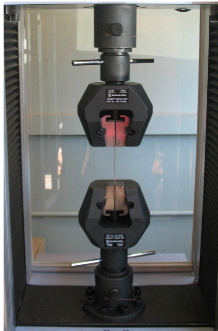
Figura 3.6. Garras utilizadas no ensaio de tração na máquina de ensaios estática servo-elétrica
