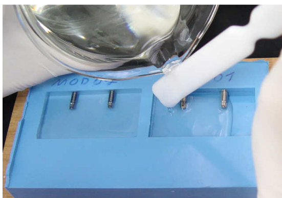
Fig. 13 - Molde de silicone contendo resina fotoelástica em polimerização.
