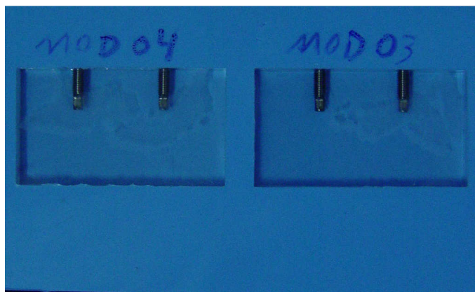
Fig. 20 - Modelos fotoelásticos contendo implantes e pilares/barra aparafusados.
