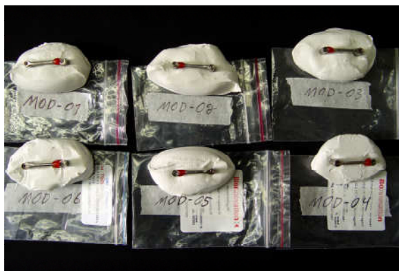
Figura 22 - Inclusão das barras em modelos de gesso.
