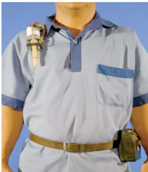
Figura 3.6 - Bomba gravimétrica ligada ao ciclone de fração respirável e meio de coleta. Fonte: FUNDACENTRO (2009).
