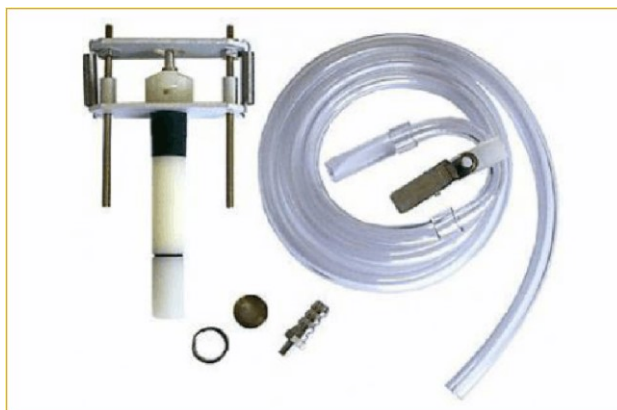
Figura 3.3 - Amostrador para coleta de material particulado respirável Fonte: RTX Ambiental (2017).
