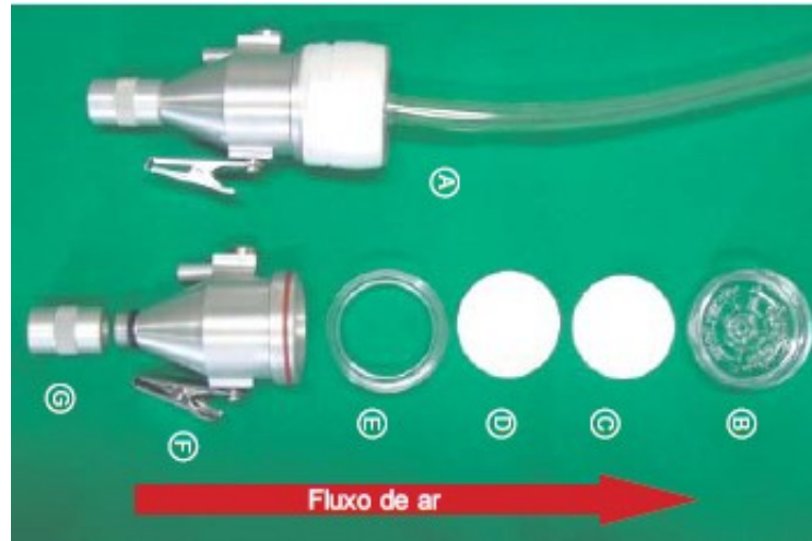
Figura 3.5 - Dispositivo de coleta para particulado torácico e respirável. Fonte: FUNDACENTRO (2009).
