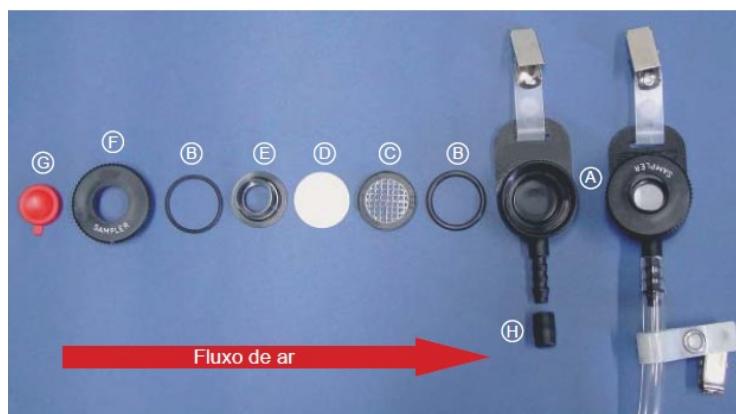
Figura 3.4 - Dispositivo de coleta tipo IOM para particulado inalável. Fonte: FUNDACENTRO (2009).
