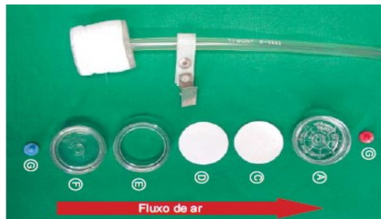
Figura 3.2 - Dispositivo de coleta para particulado total (cassete) Fonte: FUNDACENTRO, (2009).
