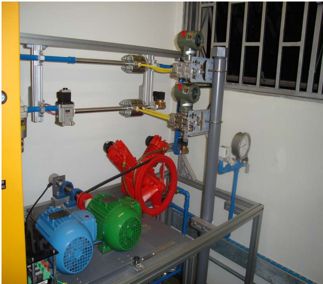
Figura 2.2 – Foto da plataforma de ensaio do sistema de ar comprimido
