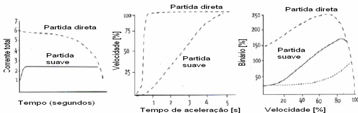
Figura 3.15 – Comparação entre arranque direto e com controlador
