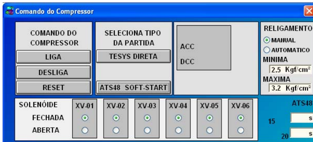
Figura 2.18 – Tela Comando do Compressor.
