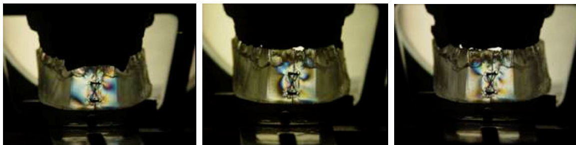
Figura 5.42 – Modelo com corte mediano e amarração cruzada e carga sendo aplicada no centro, no lado direito e no lado esquerdo da mandíbula.
