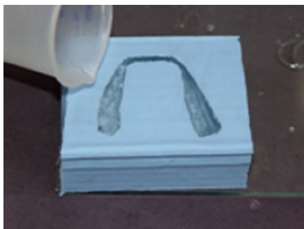
Figura 4.7 – Preenchimento do molde de silicone com a resina fotoelástica misturada.
