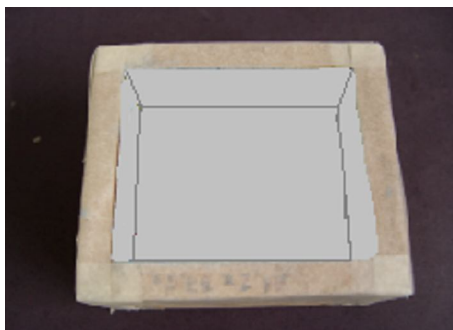
Figura 4.2 – Caixa moldeira para obtenção do modelo em resina acrílica.
