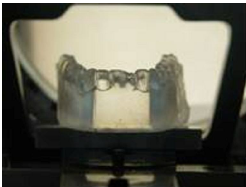
Figura 4.8 – Modelo de resina fotoelástica visualizado no Polariscópio.
