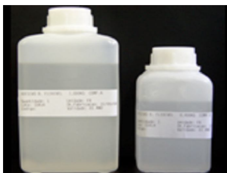
Figura 4.6 – Resina fotoelástica semi-rígida (à esquerda) e catalisador (à direita).
