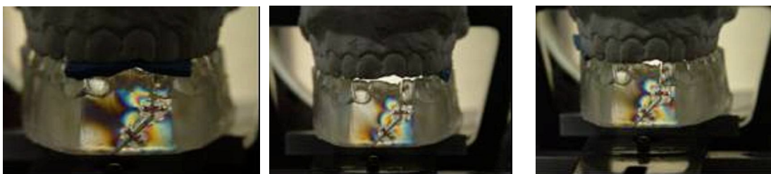
Figura 5.49 – Modelo com corte paramediano e amarração paralela e carga sendo aplicada no centro, no lado direito e no lado esquerdo da mandíbula.
