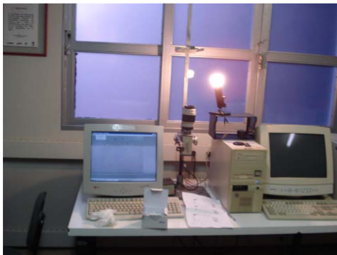
Figura 6.5- Bancada para a medição do diâmetro e penetração do cordão de solda
