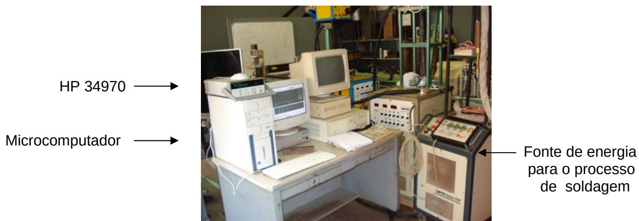
Figura 5.6- Bancada experimental: HP 34970(Data Acquisition\Control Unit), microcomputador e fonte de corrente contínua
