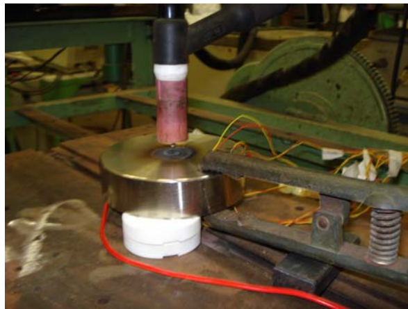
Figura 5.5- Montagem experimental: Cilindro submetido ao processo de soldagem
