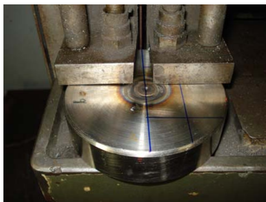
d) Corte do cilindro com o equipamento Discotom / Struers
