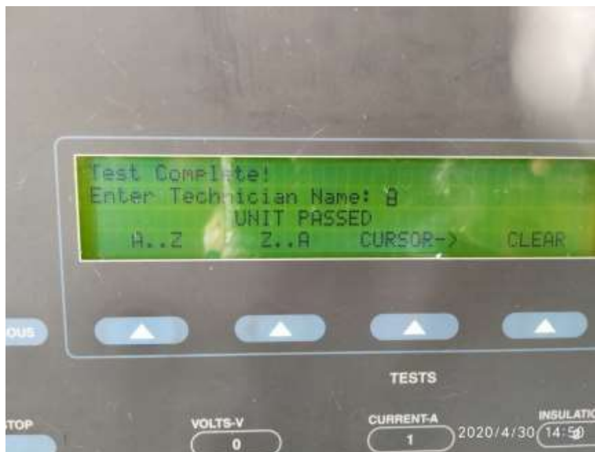
Figura 2.8: Resultado indicado no visor do analisador referente ao teste de segurança elétrica
