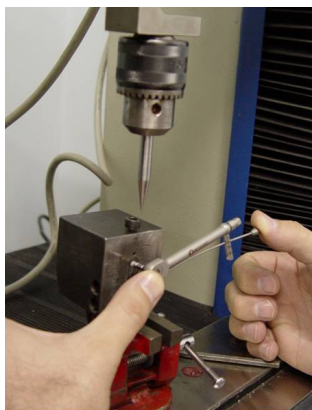
Figura 6 - Aplicação de torque de 20N ao parafuso, com torquímetro Neodent
