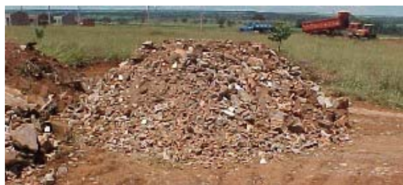
Figura 6.2 – Entulho preparado para utilização.
