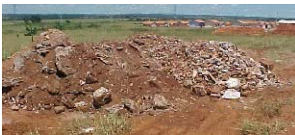
Figura 6.1 – Entulho para utilização com muita terra misturada.
