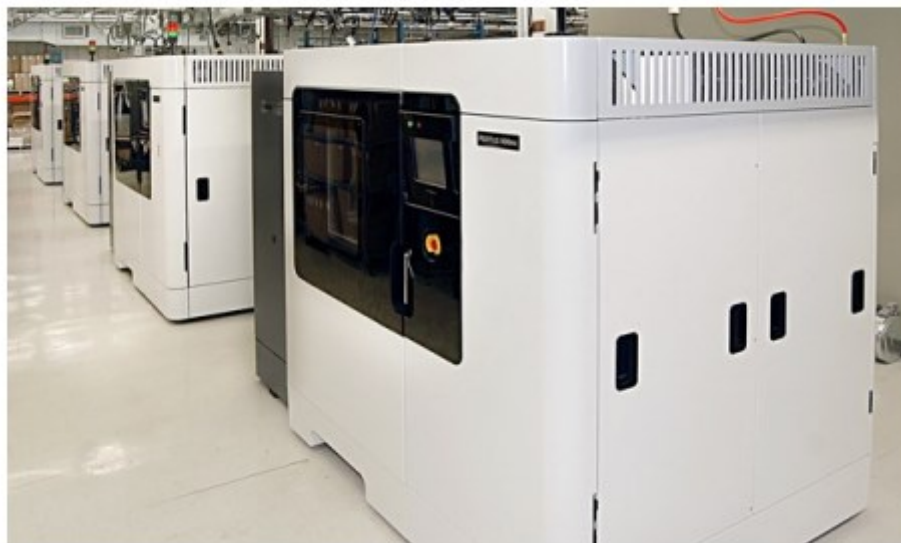
Figura 7. Impressora Stratasys Fortus 900mc 3D. Fonte: (Gebhardt,2016)
