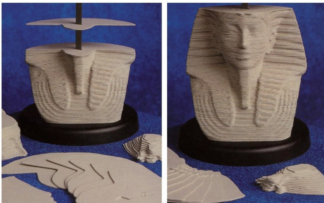
Figura 1. Princípio da tecnologia de camadas. Fonte: (Gebhardt & Hotter, 2016).
