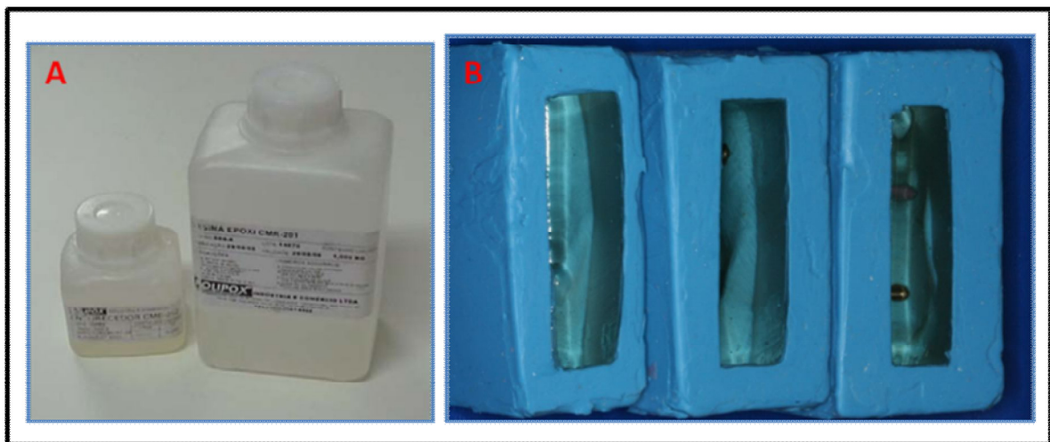
Figura 17. A. Resina flexível Polipox; B. Resina fotoelástica vertida no interior da matriz.
