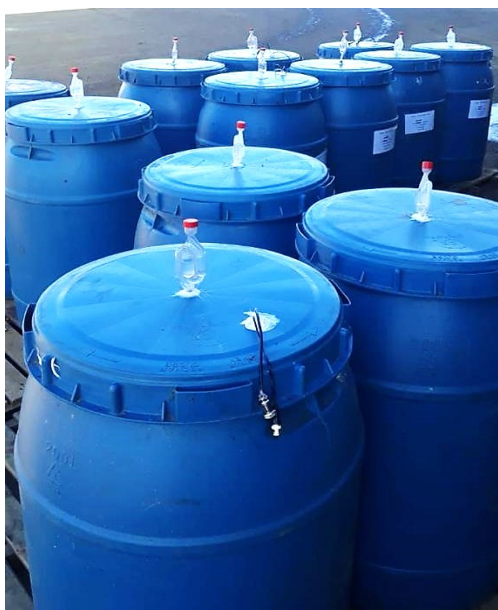
Figura 5 – Biorreatores de polietileno de alta densidade utilizados para condução de processos fermentativos em café
