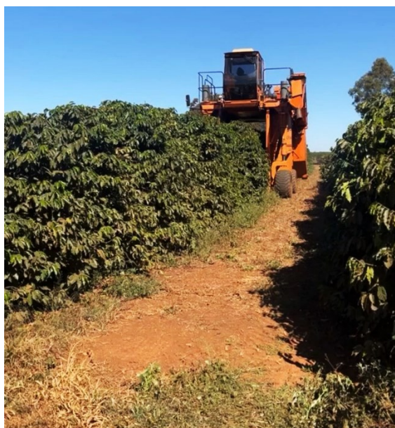
Figura 4 – Colheitadeira mecânica durante o processo de colheita de frutos de café
