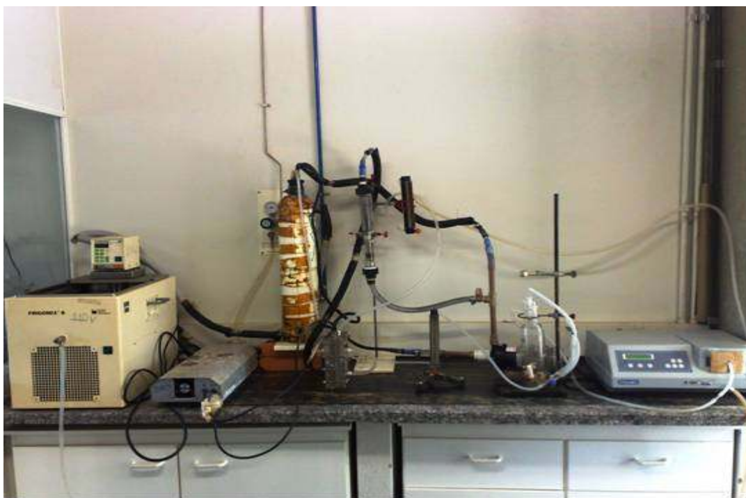
Figura 8: Fotografia do conjunto experimental empregado na geração eletroquímica de O_3 . Da esquerda para direita: sistema de refrigeração (banho ultratermostatizado), fonte de corrente contínua, frasco reservatório e separador de gases, reator eletroquímico, fluxômetro, bomba centrífuga, frasco reator e espectrofotômetro.
