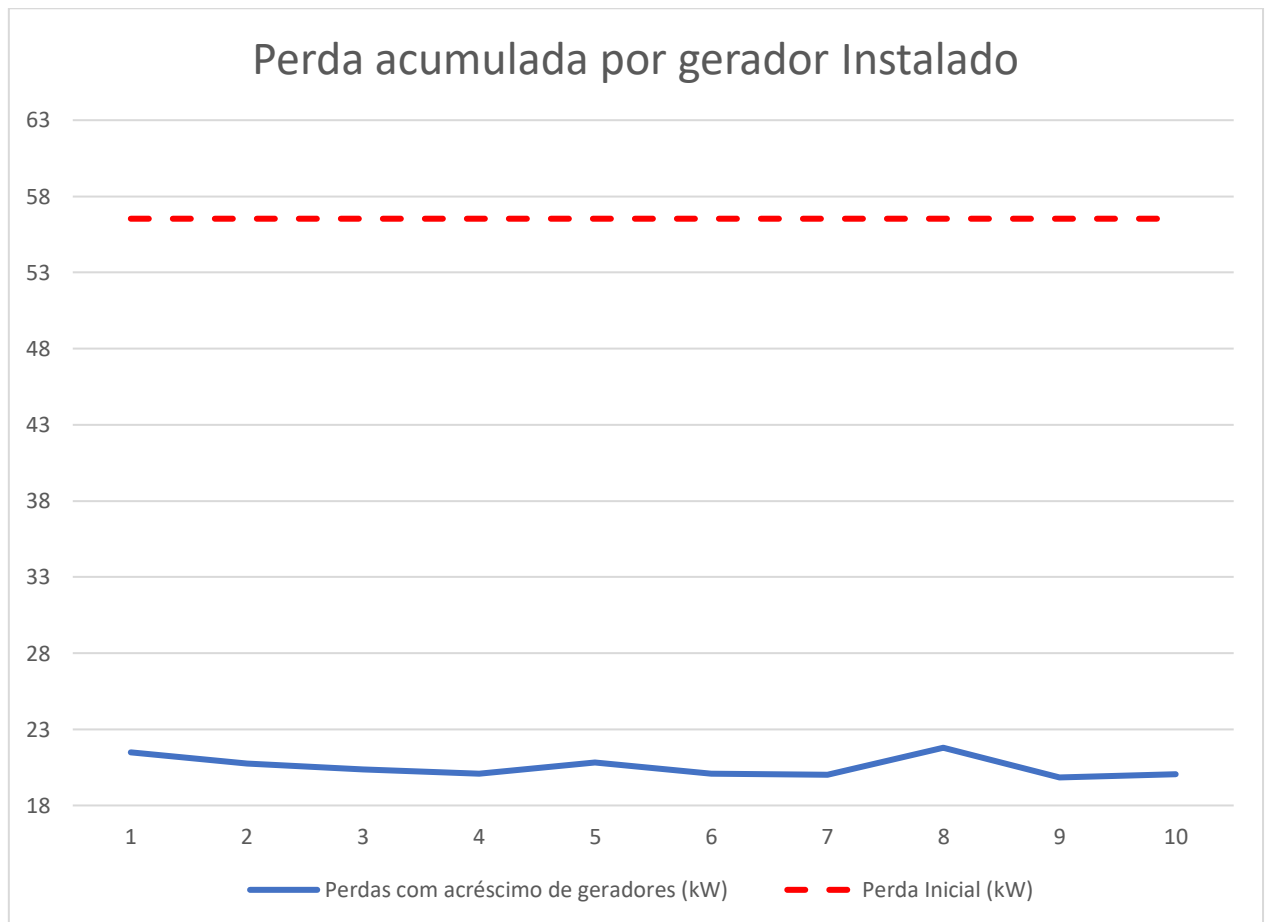
Figura 28: Perfil de perdas com a inserção de geradores para o sistema IEEE 50 barras
