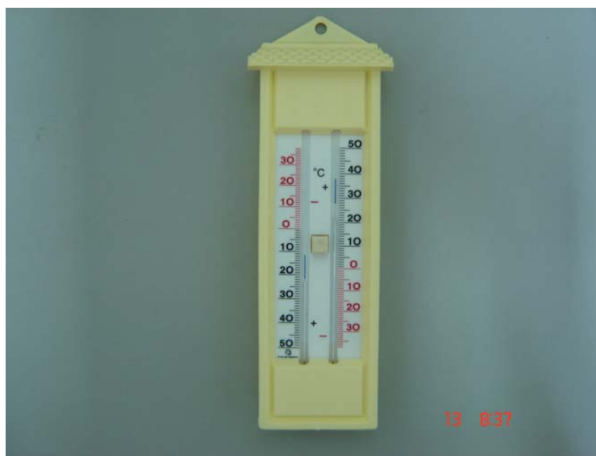
Figura 22 - Fotografia do termômetro de máxima e mínima utilizado para o monitoramento da temperatura ambiente no local de realização da pesquisa.
