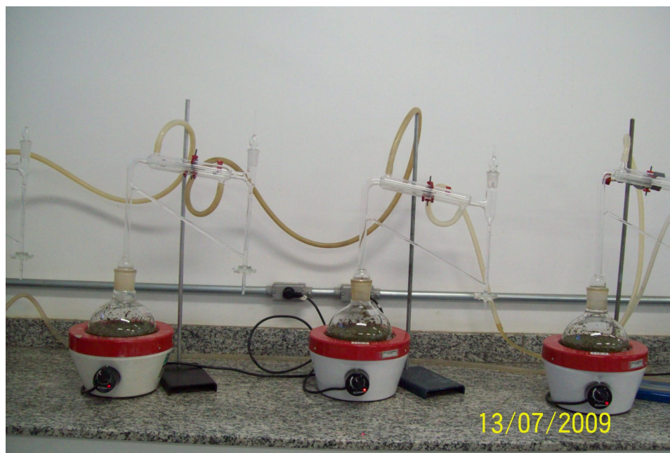
FIGURA 3. Extração de óleo essencial por hidrodestilação em aparelho tipo Clevenger. Instituto Agrônomo de Campinas (IAC). Campinas, SP. 2009.
