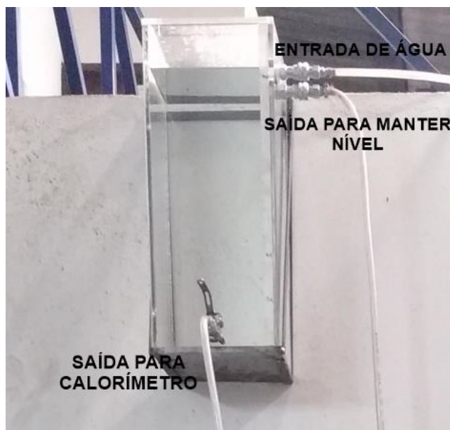
Figura 3.4 - Recipiente de armazenamento de água com capacidade aproximada de 30 litros
