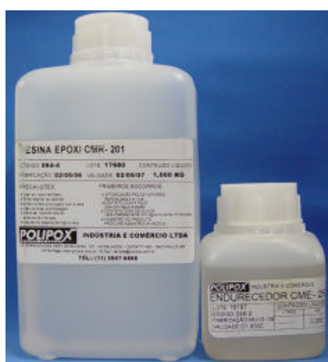
Figura 23. Resina flexível Polipox utilizada para confecção do modelo fotoelástico (componente A e B).
