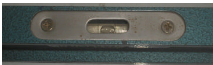
Figura 22. Nível utilizado para conferir se a superfície estava plana.
