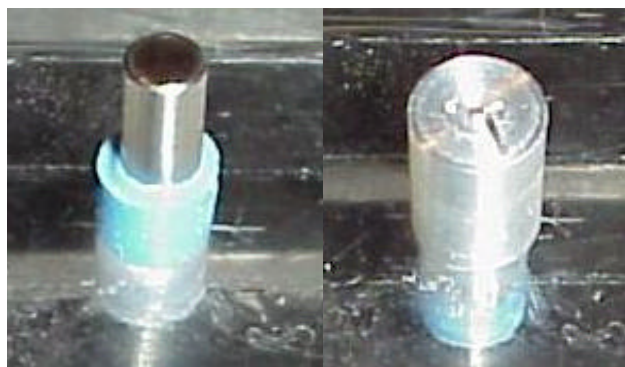
Figura 20. Posicionamento dos implantes na caixa molde com o auxílio de um gabarito.
