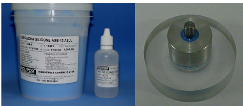
Figura 18. Borracha de silicone utilizada (Base e Catalizador) e molde com a silicone já vazada.
