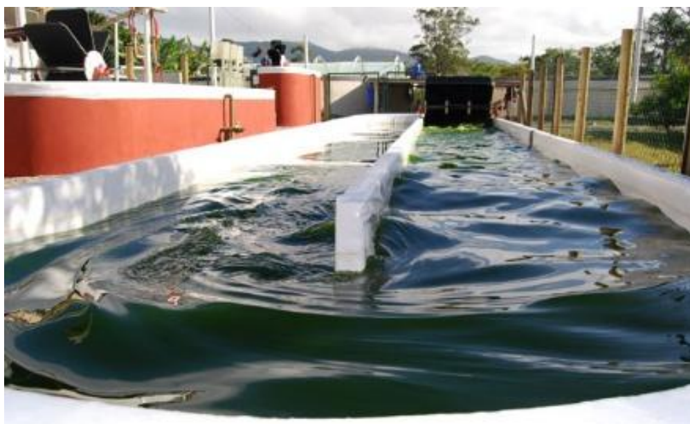
Figura 2 – Produção de microalgas em tanques abertos.
