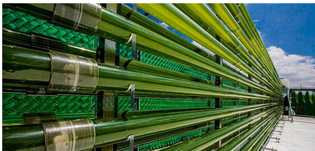
Figura 3 – Fotobiorreatores tubulares para cultivo de microalgas.
