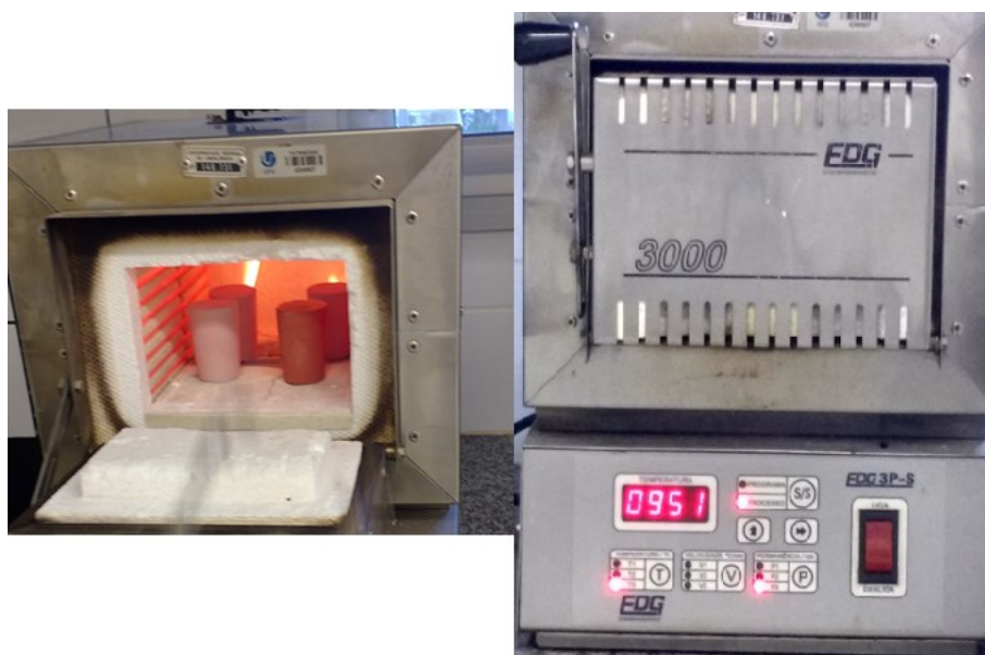
Figura 8 – Anéis de fundições levados ao forno
