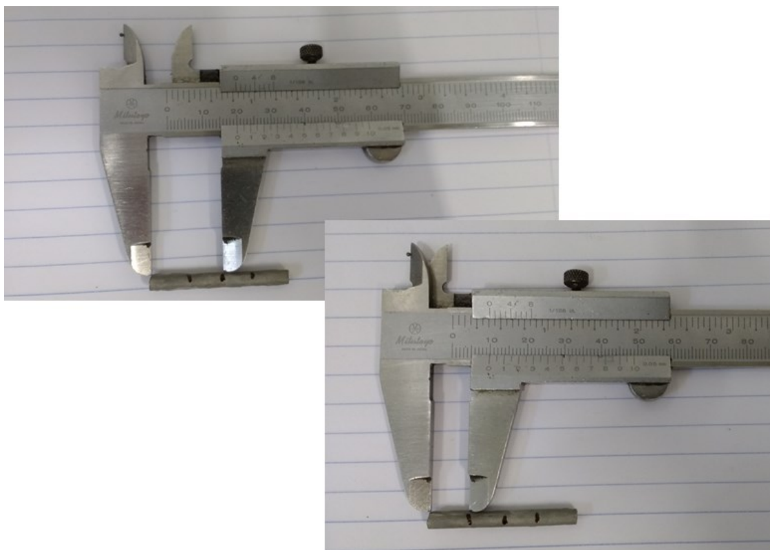
Figura 17 – Delimitação de três regiões equidistantes nos corpos de prova com o auxílio de um paquímetro
