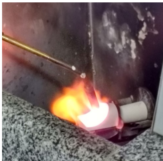
Figura 13 – Fundição pela Técnica do Maçarico
