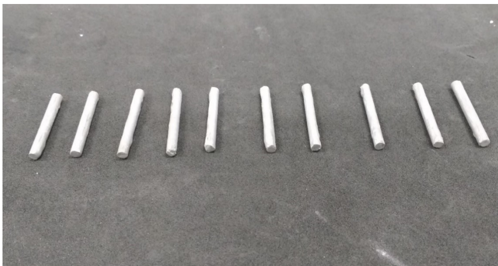
Figura 15 - Barras metálicas após o acabamento e jateamento
