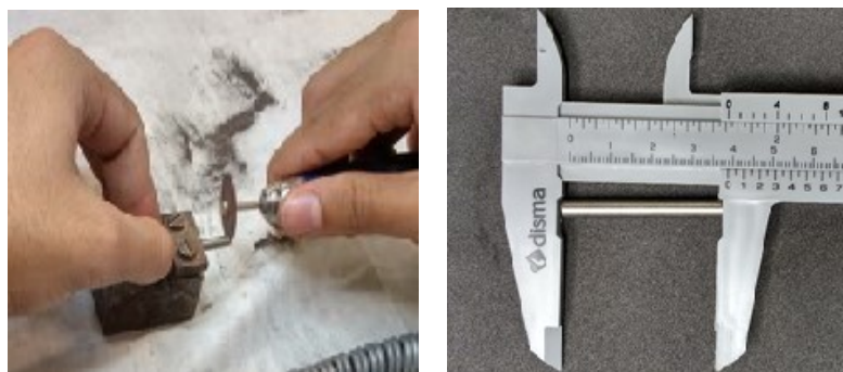
Figura 1. A. e B. Barra pré-fabricada de 4mm de diâmetro, seccionada na medida de 40mm de comprimento.
