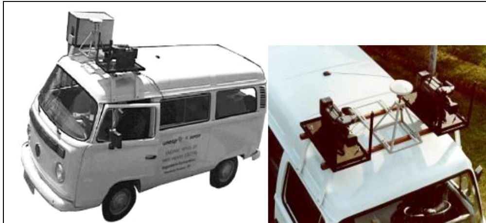
Figura 2 – Unidade Móvel de Mapeamento Digital (UMD) desenvolvida na FCT/Unesp.
