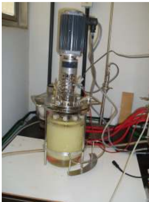
Figura 3.2- Foto do fermentador Biostat-B utilizado para realizar os ensaios.
