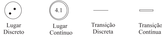
Figura 2.19: Representação de Lugares e Transições em uma Rede de Petri Híbrida
