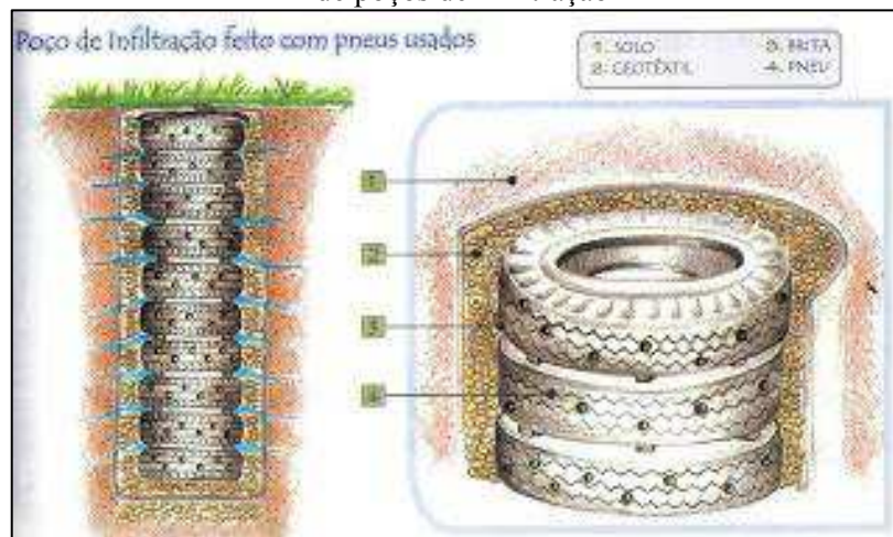
Figura 37 - Esquema de uma alternativa econômica de poços de infiltração
