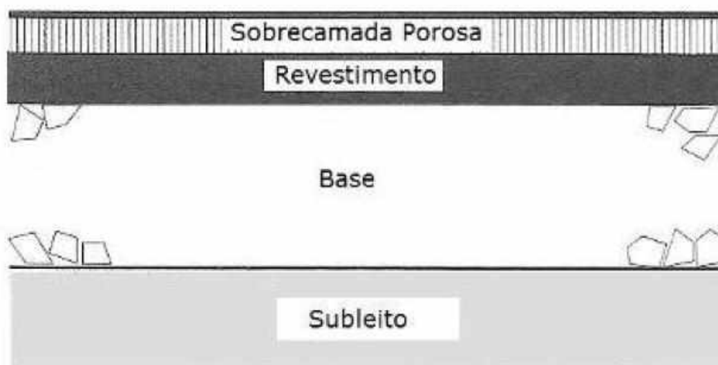
Figura 4 - Sobrecamada de material poroso sob revestimento convencional
