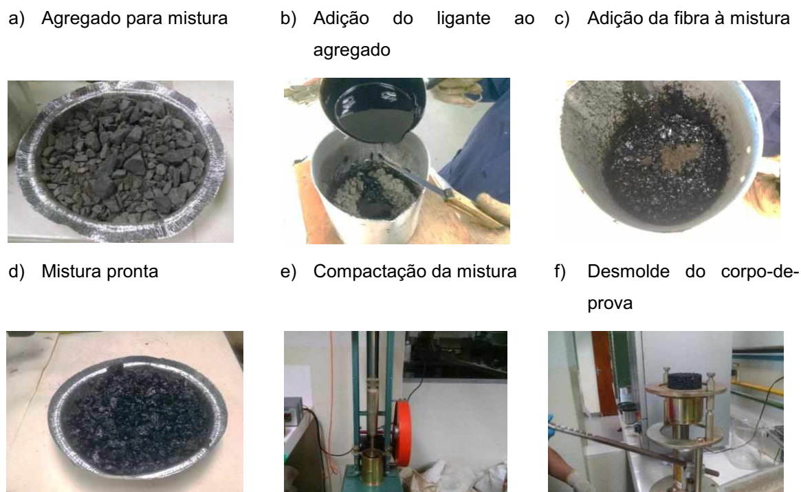
Figura 19 - Algumas etapas da preparação da mistura para ensaio Marshall
