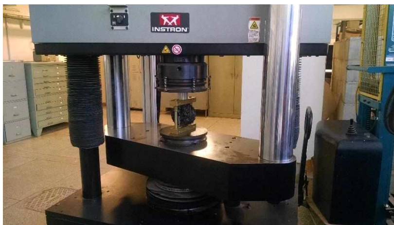
Figura 23 - Realização do ensaio de resistência a compressão diametral
