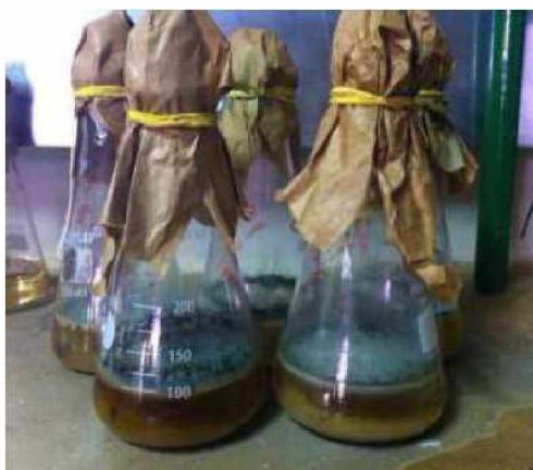
Figura 3.6- Avaliação preliminar da capacidade de biossolubilização dos 16 isolados fúngicos em meio sintético seletivo modificado líquido em reatores cônicos de bancadas a 27 \pm 3^\circ\text{C} após 12 dias.
