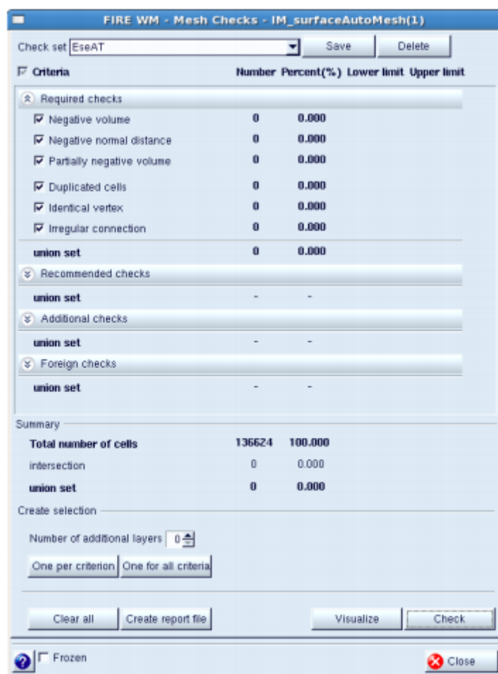
Figura 21 Ferramenta para checar a qualidade da malha criada
