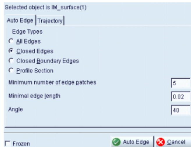
Figura 16 Ferramenta e valores para criação de uma malha com seleção da opção “Bordas Fechadas”.
