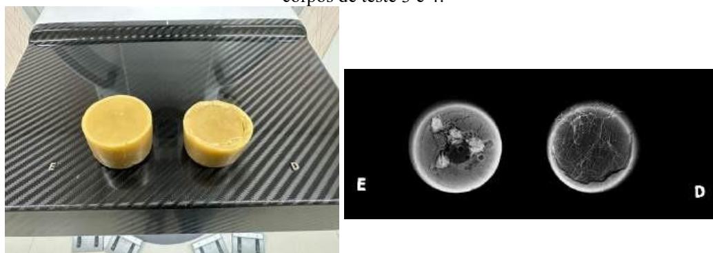
Figura 50 – Esquerda: corpos de teste 3 e 4 finalizados, já posicionados no equipamento mamográfico para a aquisição das imagens e Direita: uma imagem mamográfica realizada dos corpos de teste 3 e 4.
