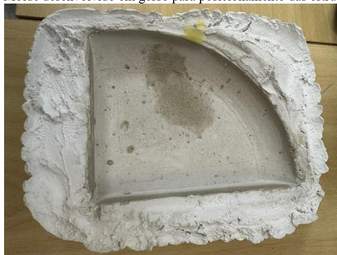
Figura 41 – Molde desenvolvido em gesso para posicionamento das estruturas de teste
