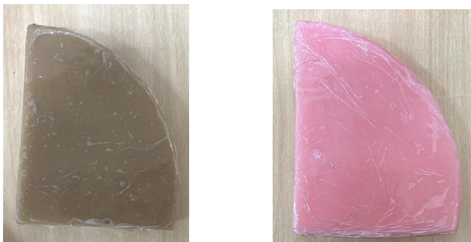
Figura 55 – Modelos desenvolvidos com a estrutura MR.Sup, Esquerda: Cera de Abelha MR.Sup 1 e Direita: Cera Odontológica MR.Sup 2.
