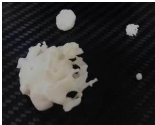
Figura 22 - Modelos impressos para simular nódulos circunscritos e espiculados.
