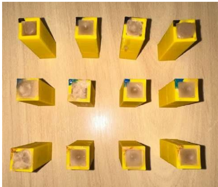
Figura 34 – Corpo de Teste 5 para avaliação de padrão de preenchimento e espessura de material do phantom , a espessura utilizada de PLA aumenta da esquerda para a direita na mesma fileira, cujas estruturas possuem a mesma pigmentação em sua região superior (preto, azul ou dourado).
