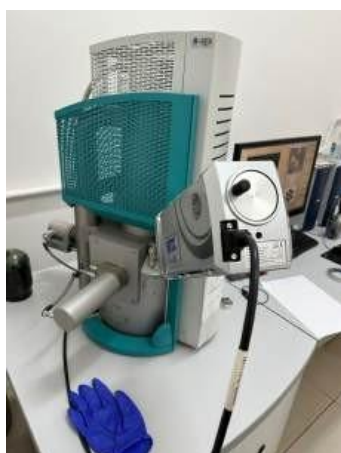
Figura 24 – Esquerda: Equipamento utilizado para medida das frações de massa de cada amostra dos materiais candidatos. Direita: Amostras de cera de abelha, cera odontológica rosa 9, cera odontológica rosa 7, fibra de vidro, parafina e parafina em gel.
