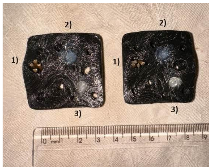
Figura 31 - Formato com protuberância e furos (FPF) com as estruturas em 1) PETG, 2) silicone e 3) fibra de vidro posicionadas nos furos.
