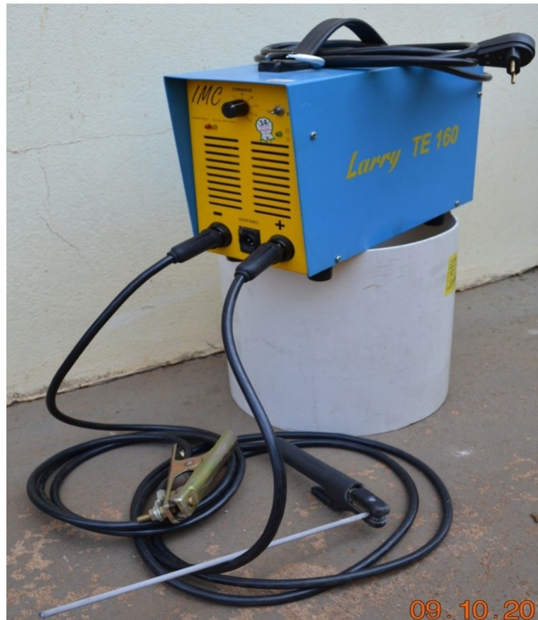
Figura 3.3.1 – Equipamento de soldagem utilizado no método Eletrodo Revestido
