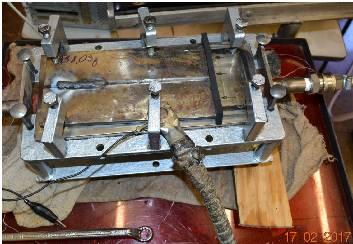
Figura 5.1 - Solda com eletrodo revestido.
