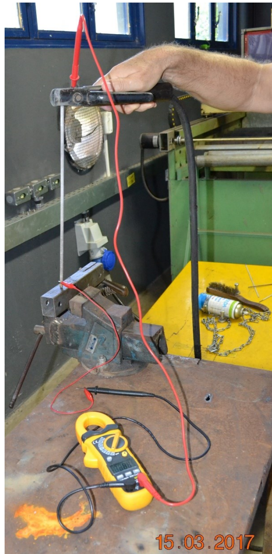
Figura 4.5 – Multímetro mensurando voltagem.
