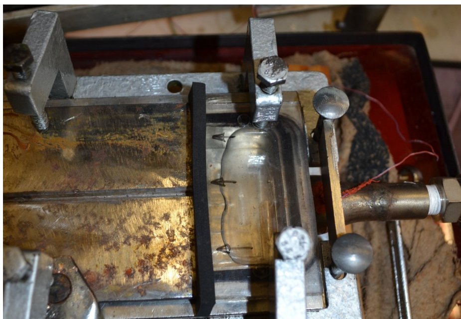
Figura 4.3 - Bolha de ar deslocada para uma extremidade do calorímetro.
