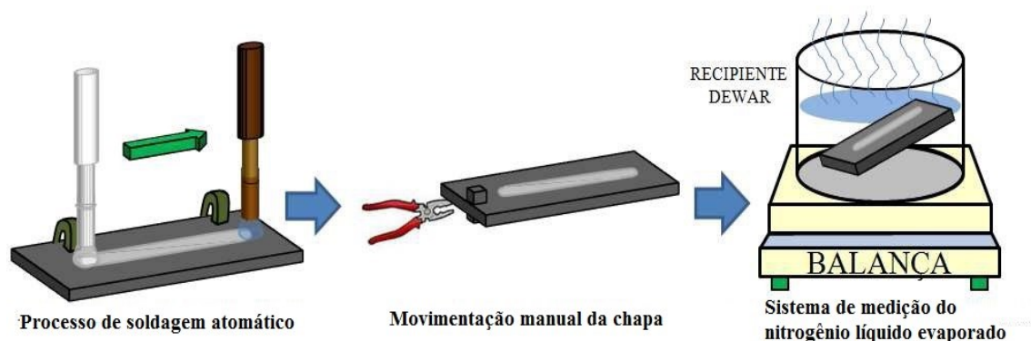
Figura 2.3 - Esquema do calorímetro de nitrogênio líquido e de medição da massa do N_2L evaporada (AREVALO, 2011).
