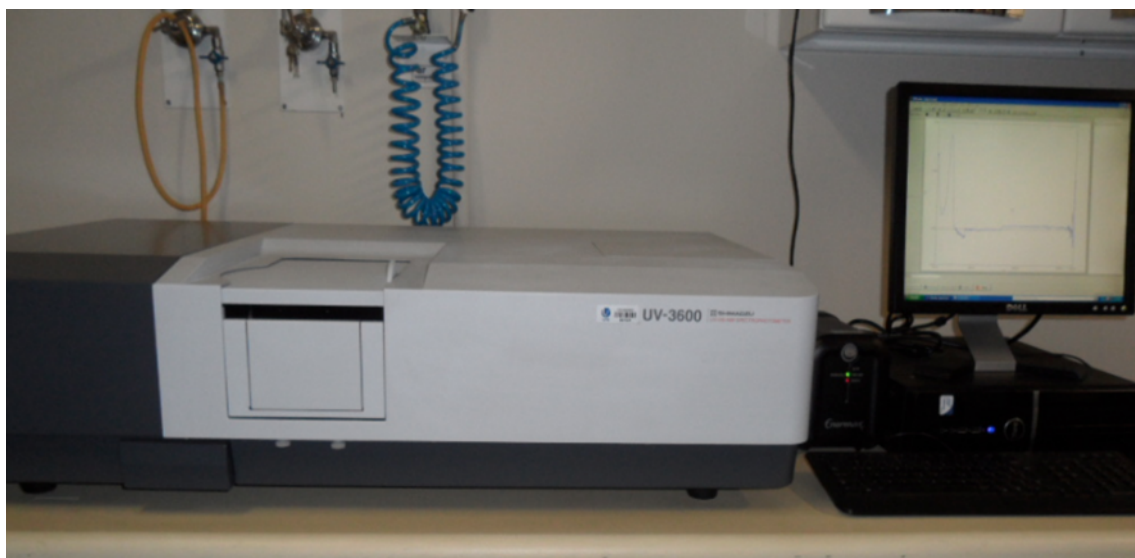
Figura 3.13. Foto do espectrômetro UV-3600 uv-vis nir do grupo de pesquisa do Prof. Noélcio O. Dantas (LNMIS /INFIS /UFU).
