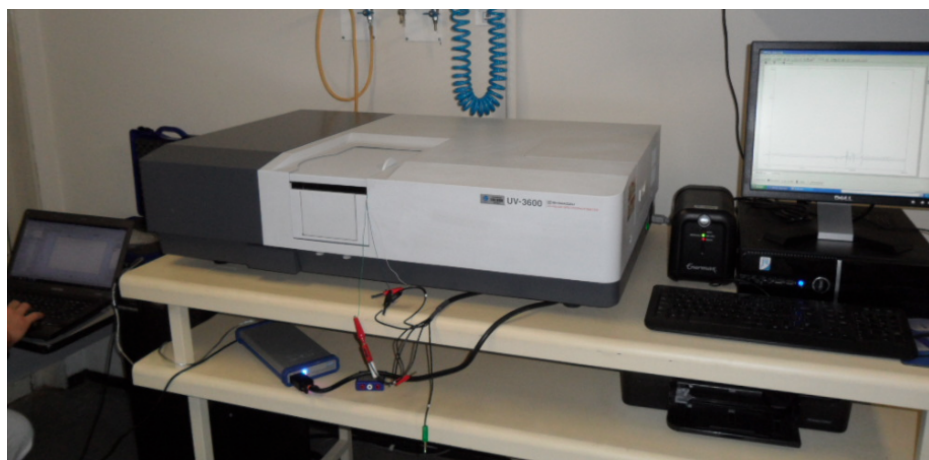
Figura 3.15. a) Esquema da célula eletroquímica utilizada, b) Foto da montagem experimental da medida de UV-vis in situ .
