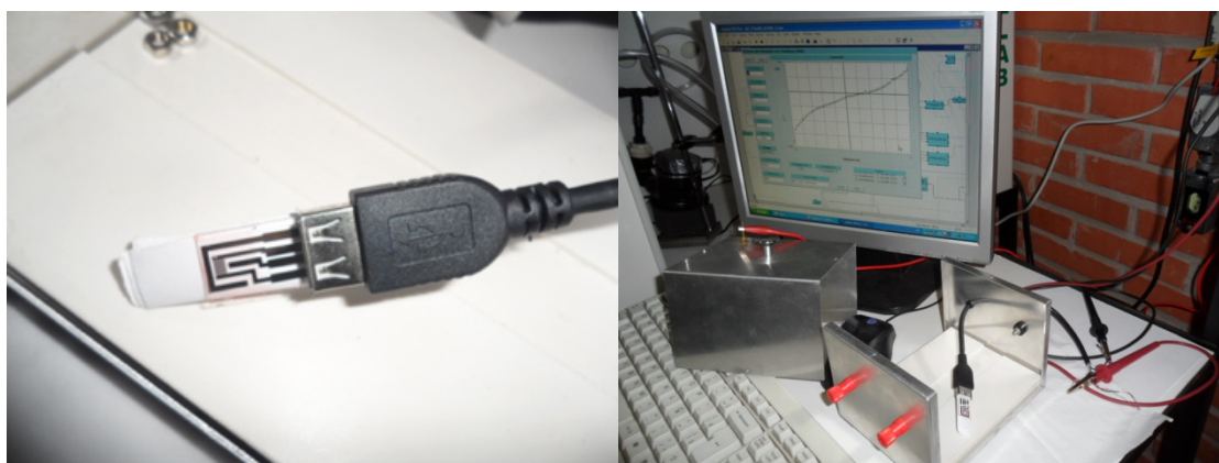
Figura 3.20. Eletrodo IDA conectado a USB (esquerda) e montagem experimental (direita).
