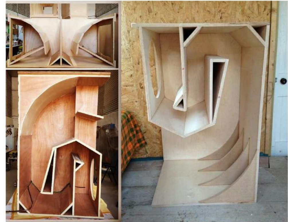
Figura 36. Detalhes evidenciando o interior das caixas que servem de suporte para speakers, HD 215 e Superscoops (uma caixa para speakers posicionados acima e outra para baixo) Disponível em < https://br.pinterest.com/pin/402157441723713758/ >
