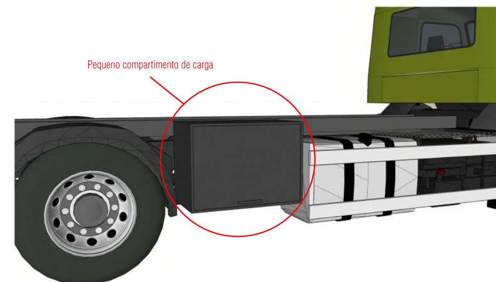
Figura 31. Detalhe do compartimento de carga fixado no chassi
