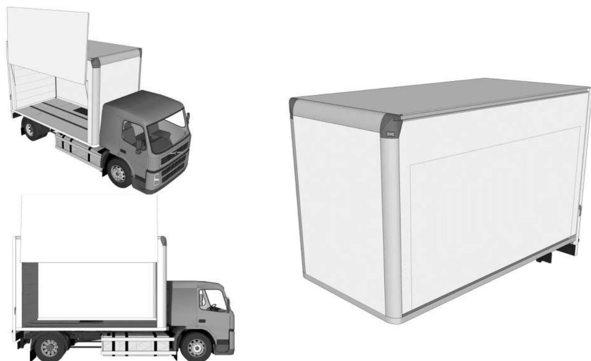
Figura 26. Baú com lateral retraída e exemplos do baú com a lateral expandida
