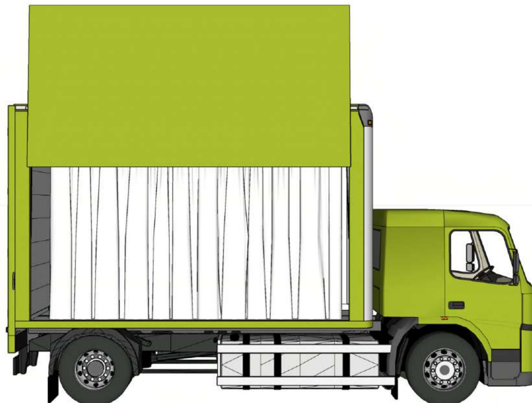
Figura 33. Visão externa da cortina com a lateral do baú expandida
