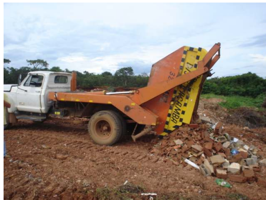
Figura 4.32 – Caminhão com caçamba estacionária e poliguindaste.
