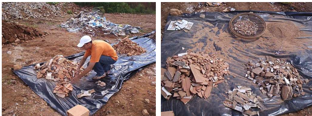
Figura 4.50 – Separação das fases constituintes Figura 4.51 – Fases encontradas na Caçamba 1
