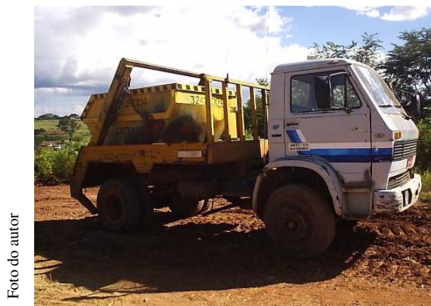
Figura 4.56 –Caminhão com poliguindaste.
