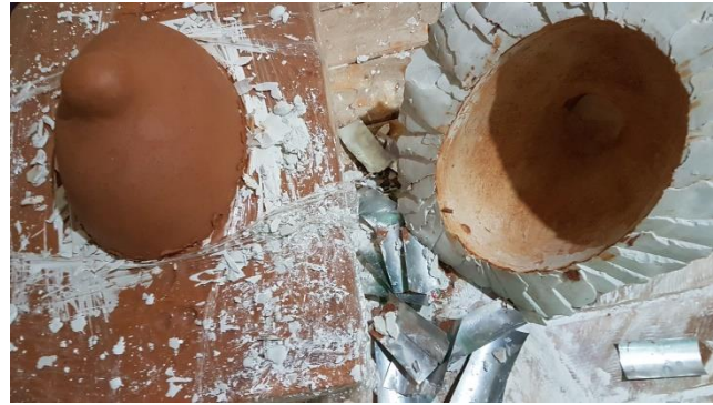
Figura 6 – Retirando o molde negativo
