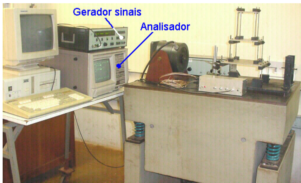
Figura I.2 – Analisador e gerador de sinais durante o ensaio de identificação padrão do sistema de 3 gdl.
