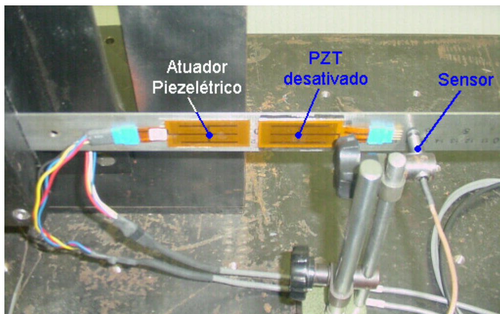
Figura I.4 – Sensor de proximidade e atuador piezelétrico da face anterior da viga engastada-livre.
