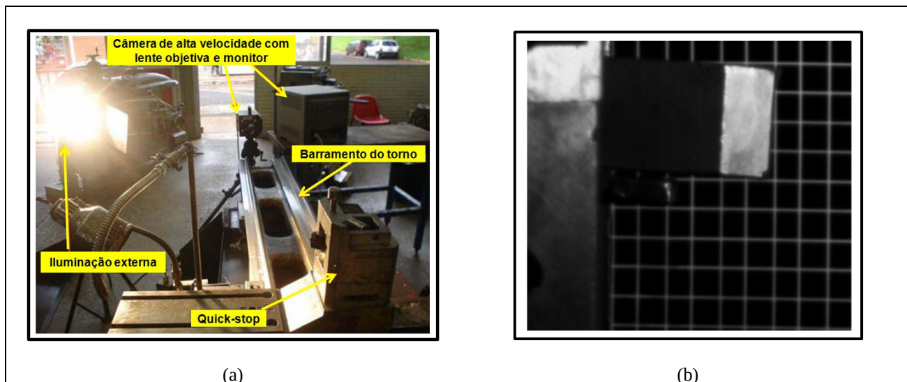
Figura 4 – Montagem da câmera de alta velocidade sobre o torno; b) Porta-ferramenta momentos antes de iniciar os testes.
