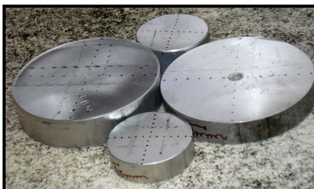
Figura 3.4 - Amostras após ensaios de Dureza Brinell
