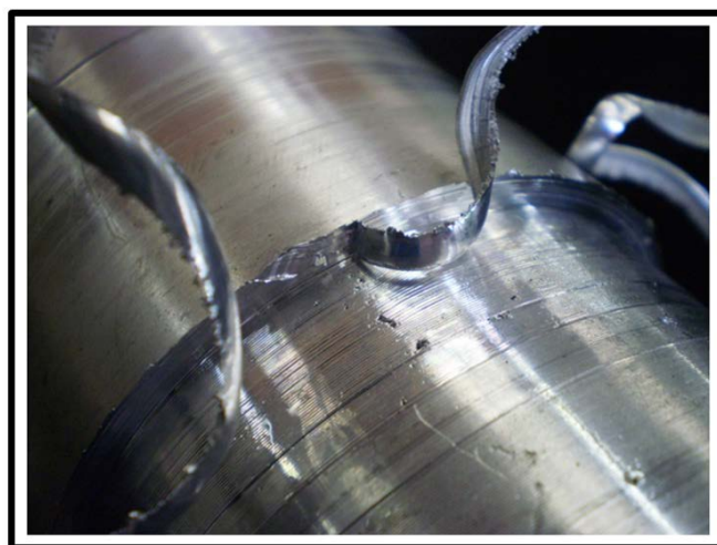
Figura 2.24 - Exemplos de raiz de cavaco obtidas através de ensaio quick-stop (NASCIMENTO et al., 2010)
