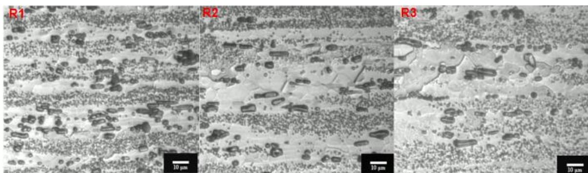
Figura 3.6- Microestrutura da liga 3030 T4.
