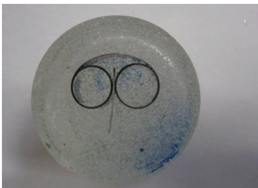
Figura 3.13 - Amostra embutida, polida e atacada.
