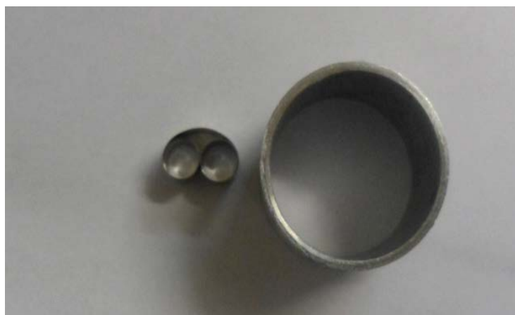
Figura 3.12 - Grampo e suporte utilizados para embutir os cavacos
