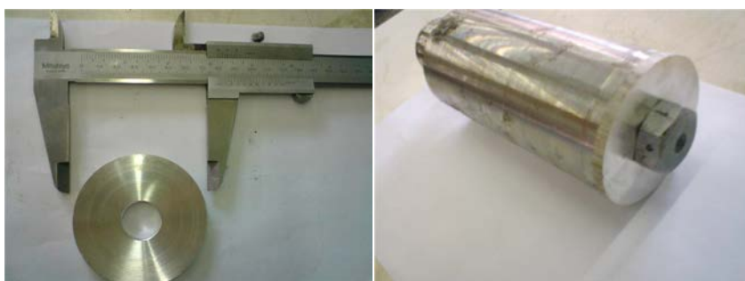
Figura 3.16- Formato dos corpos de provas em formas de anéis e dispositivo de fixação para realização dos testes de quick-stop.
