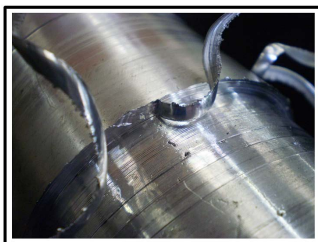
Figura 9 – Teste 1 ( V_c = 132 mm/min; f = 0,323 e a_p = 3 mm).
