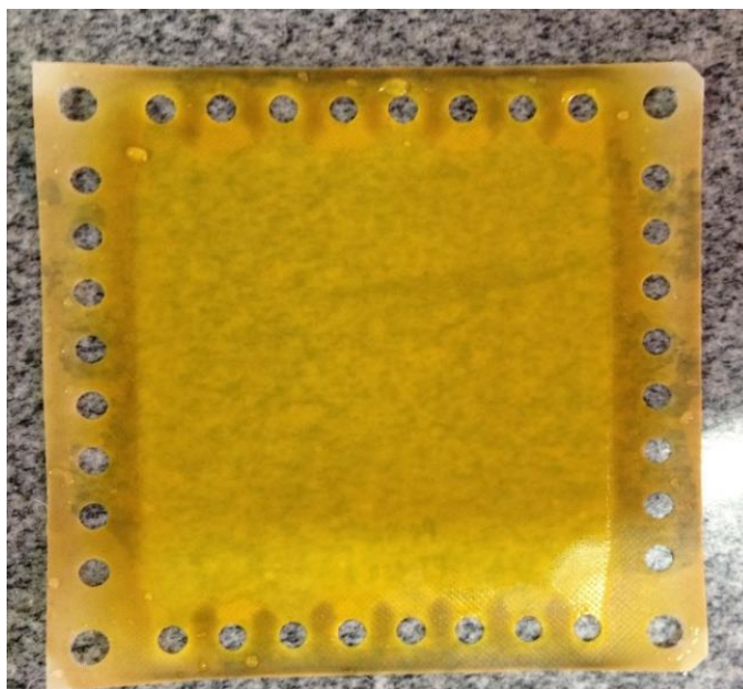
Figura 6 – Exemplo de membrana com Fouling
