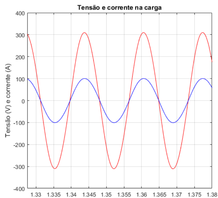
Figura 25 - Forma de onda de tensão e corrente simulados no Matlab
