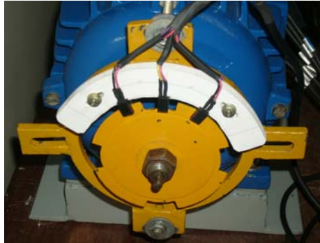
Figura 5.6 - Suporte, disco e sensores óticos de posição do rotor
