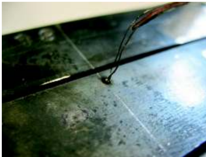
Figura 11.3 – Ilustração da posição do termopar na placa de teste em relação à junta de soldagem
