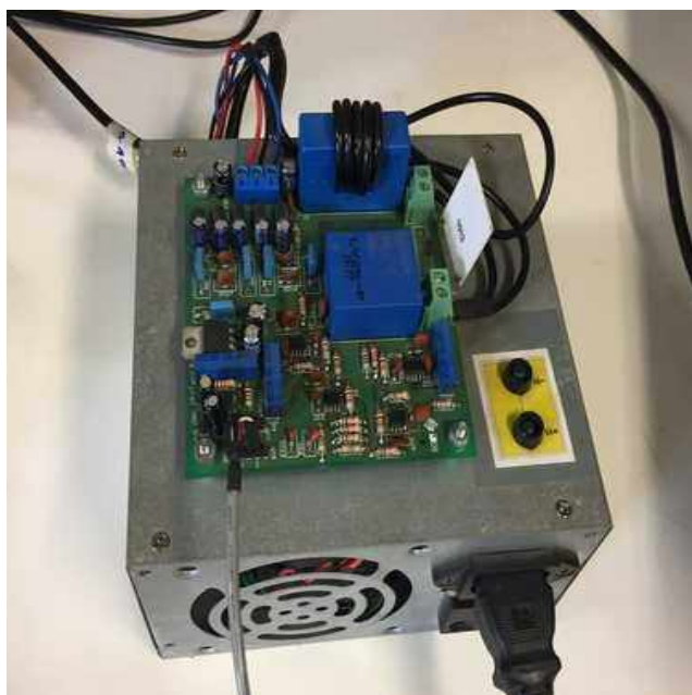
Figura 6 - Placa de aquisição e condicionamento e fonte de alimentação
