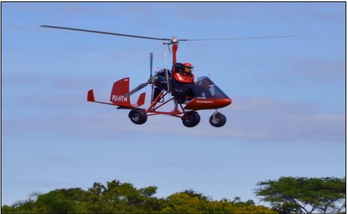
Figura 18 – HUMMINGBIRD H1 (GIROCÓPTERO 1 MOTOR A PISTÃO). Disponível em: < https://ndmais.com.br/noticias/girocopteros-produzidos-em-joinville-ganham-os-ares-do-mundo/ >. Acesso em: 29 set. 2021.
