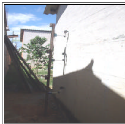
Figura 5.63 – Relógios comparadores colocados no lado oposto da parede onde se realiza o ensaio de sustentação de rede de dormir.
