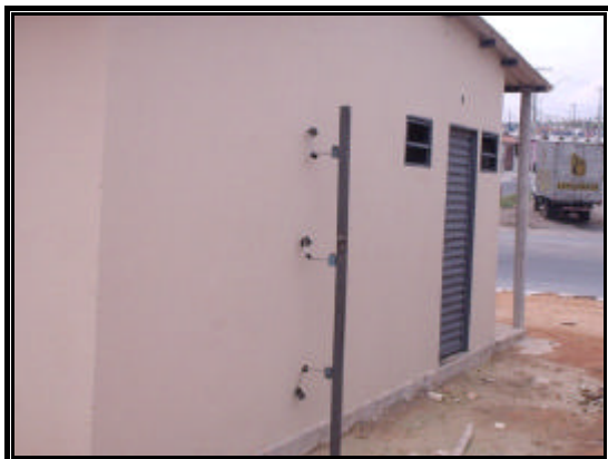
Figura C.13 – Posicionamento dos relógios comparadores (sustentação de rede de dormir).
