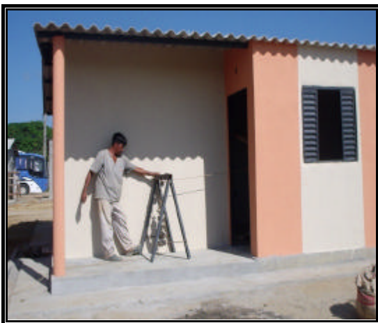
Figura C.11 – Ensaio de interação entre paredes e portas (fechamento brusco).
