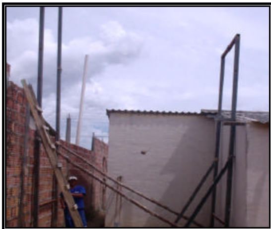
Figura C.7 - Ensaio de impacto de corpo duro (solo-cimento rejuntado).
