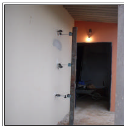
Figura 5.33 – Colocação dos relógios comparadores.
