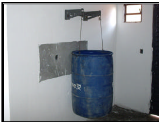
Figura C.10 - Mão-francesa e dispositivo de carga.
