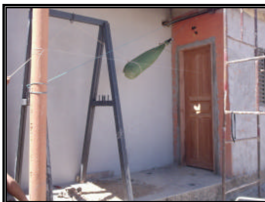
Figura 5.60 – Ensaio de interação entre paredes e portas – impacto de corpo mole.
