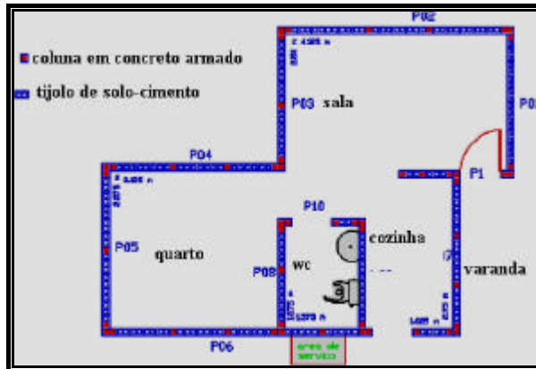
Figura 4.7 – Planta baixa da casa de solo-cimento.
