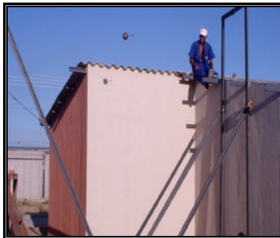
Figura C.8 - Ensaio de impacto de corpo duro (concreto celular armado).
