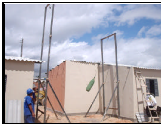
Figura 5.13 – Realização do ensaio de corpo mole.
