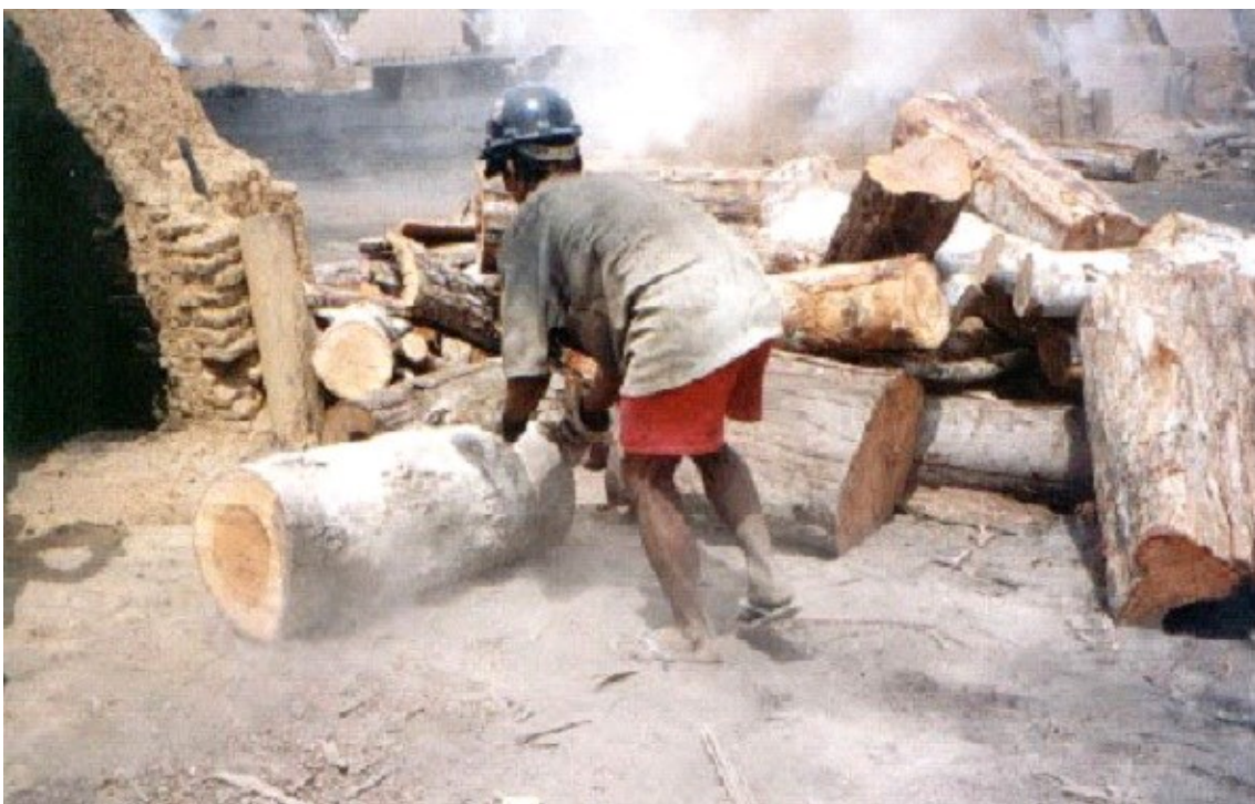
Foto 32 - Trabalhador na carvoaria sem Equipamento de Proteção Individual contra os riscos a que está exposto – Acervo Grupo Especial de Fiscalização Móvel – SIT Secretaria de Inspeção do Trabalho/Ministério do Trabalho e Emprego.
