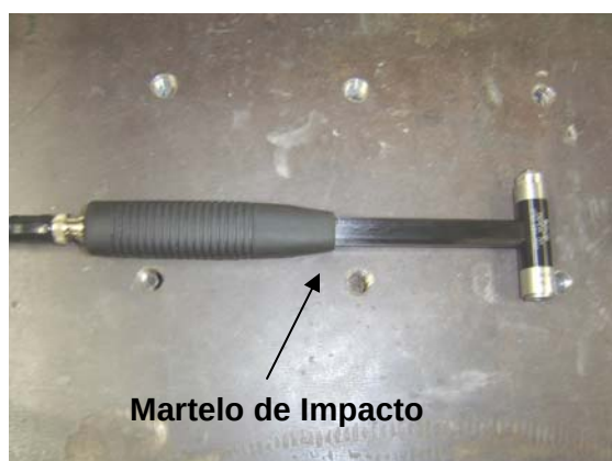
Figura 4.1. Ilustração da bancada experimental utilizada para ensaio da placa com ADVM.
